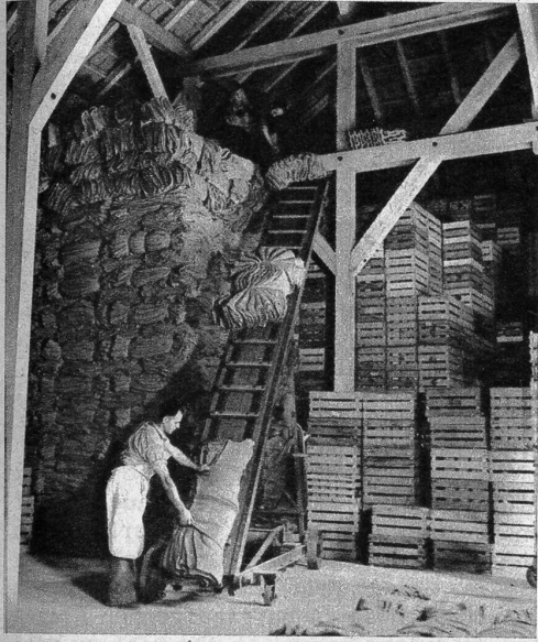
Links: Ausschnitt des Em- ballage-Lagers. Aufstapeln der sau- beren, sortierten und gebündelten Säcke mit dem Motorstapler
