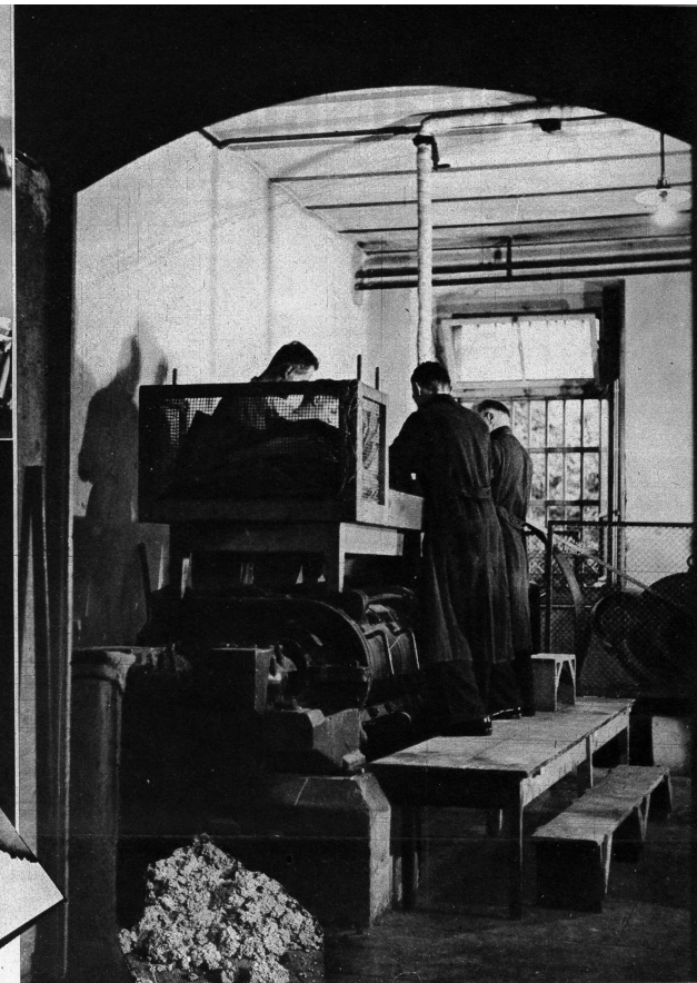
Hier hauchen die abgeschriebenen Banknoten ihr Leben aus. Die Zerfasermaschine in der Eidgenössischen Münz an der Arbeit
