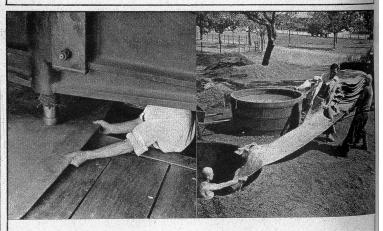
Das Sohlleder unter dem Klopfhammer bekommt die nötige Dichte und Festigkeit Eine Grube wird geleert. 4mal werden die Häute mit frischer Eichenrinde in die Gruben eingelegt.
