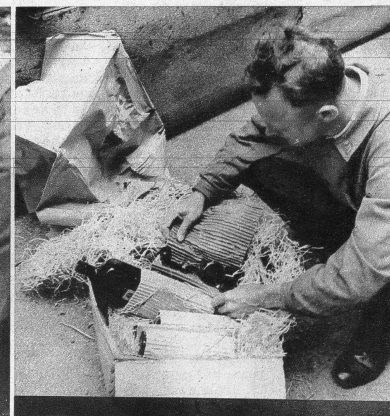
Hier wurde zwar viel Holzwolle verwendet, aber die Wellkartonschachtel war als Versandbehälter viel zu instabil. Eine Flasche ging deshalb in Stücke
