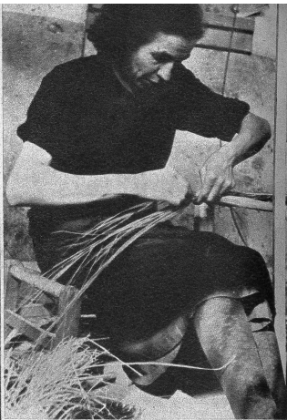
Hier wird der Schilfsitz eines Stuhles geflochten
