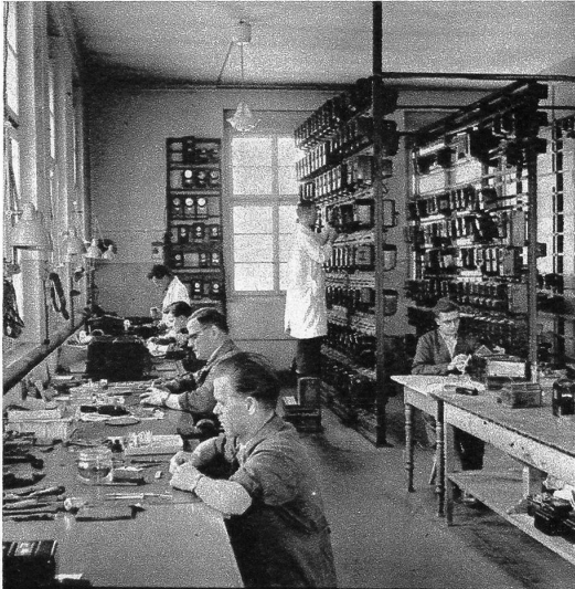
Zerlegte Zähler werden mechanisch revidiert und gereinigt. Schaltuhren werden auf genauen Gang einreguliert
