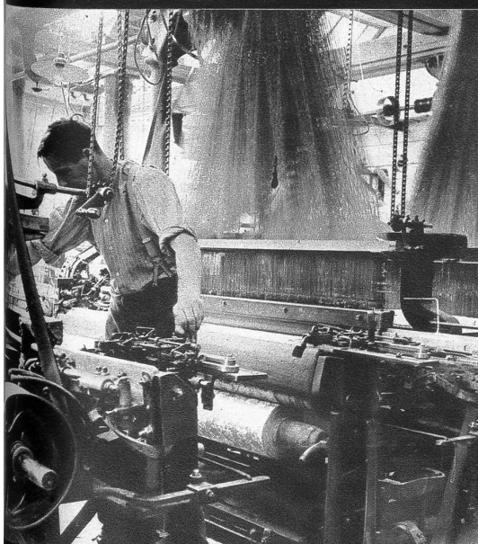
Und auf Jacquardstühlen werden die geblumten Dessins der Matratzendrilliche gewoben
