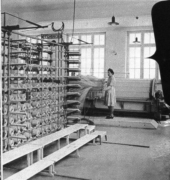
Eine Hochleistungszettelmaschine stellt die Ketten her, die nachher auf den Webstühlen zu Tuch verwoben werden
