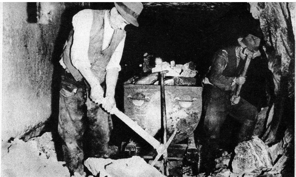
Das ausgesprengte Steinsalz wird im Stollen mit der Spitzhacke zerkleinert und in die Grubenhunde verladen
