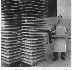
Fertiges Biskuit wird abgekühlt und nachher in Büchsen verpackt
