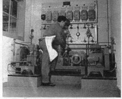
Eine moderne Kälteanlage ermöglicht, dass die in hochglanzpolierte Formen eingegossene Schokolademasse im Eintafelverfahren richtig erstarrt (abgekühlt wird)
