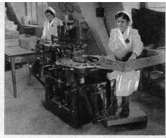
Modernste Wickelmaschinen umgeben Ausfuhrartikel mit ansprechender Hülle. Stengel werden eingewickelt
