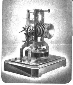
äusserst geringe Abnutzung, die so weit geht, dass man auf Schmieröl gänzlich verzichten konnte. Dieses Fehlen der Oelung hat wiederum die Beständigkeit der Regulierfähigkeit zur Folge. Ausserdem wurde bei der Konstruktion des gesamten Räderwerkes der Atmos danach getrachtet, die Energ'everluste möglichst zu verringern. Alle Triebe haben einen grossen Durchmesser, die Zapfen dagegen sind von möglichst geringen Ausmassen.
