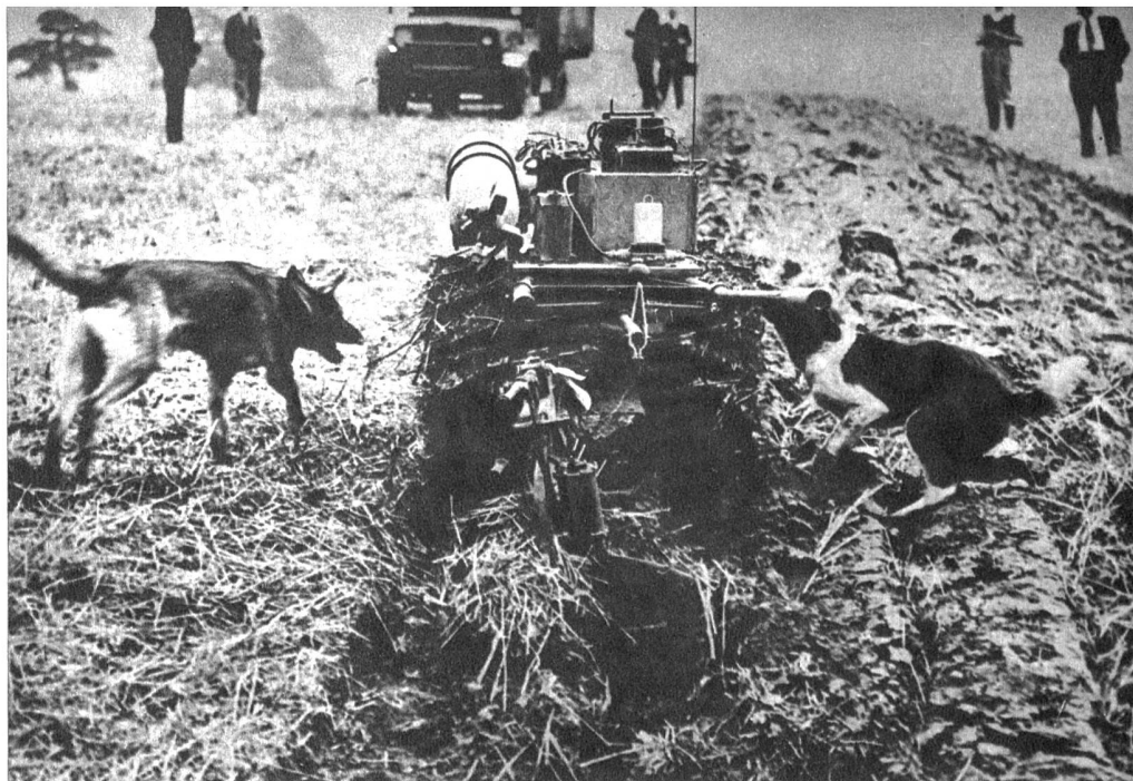
Eine geradezu epochale Erfindung ist in England geglückt: der radiogesteuerte Pflug, der durch einen einfachen Druck auf den Knopf betätigt und dirigiert wird und der an Leistung das Zehnfache eines Motorpfluges herausbringt. Unser Bild hält einen der restlos geglückten Versuche auf einem ehemaligen Schiessplatz fest. Man erkennt die Antenne und die Radio-Empfangstation auf dem Pflug, der allein Furchen zieht. (ATP)
