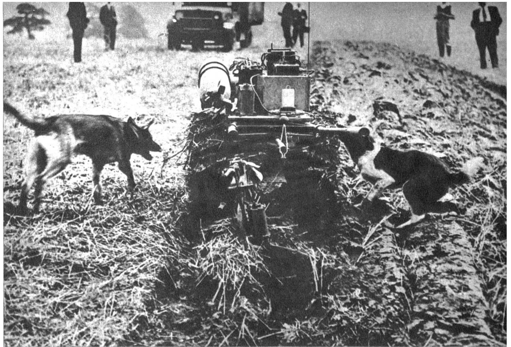
Eine geradezu epochale Erfindung ist in England geglückt: der radiogesteuerte Pflug, der durch einen einfachen Druck auf den Knopf betätigt und dirigiert wird und der an Leistung das Zehnfache eines Motorpfluges herausbringt. Unser Bild hält einen der restlos geglückten Versuche auf einem ehemaligen Schiessplatz fest. Man erkennt die Antenne und die Radio-Empfangstation auf dem Pflug, der allein Furchen zieht. (ATP)
