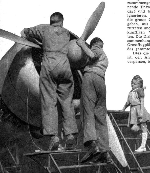
Eine riesige Motorhaube mit verstellbaren Kühlklappen (Photopress Zürich)
