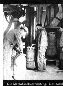
Die Mehlabsackvorrichtung. Das Meh wird in Säcke gefüllt und zum Abtransport bereitgestellt
