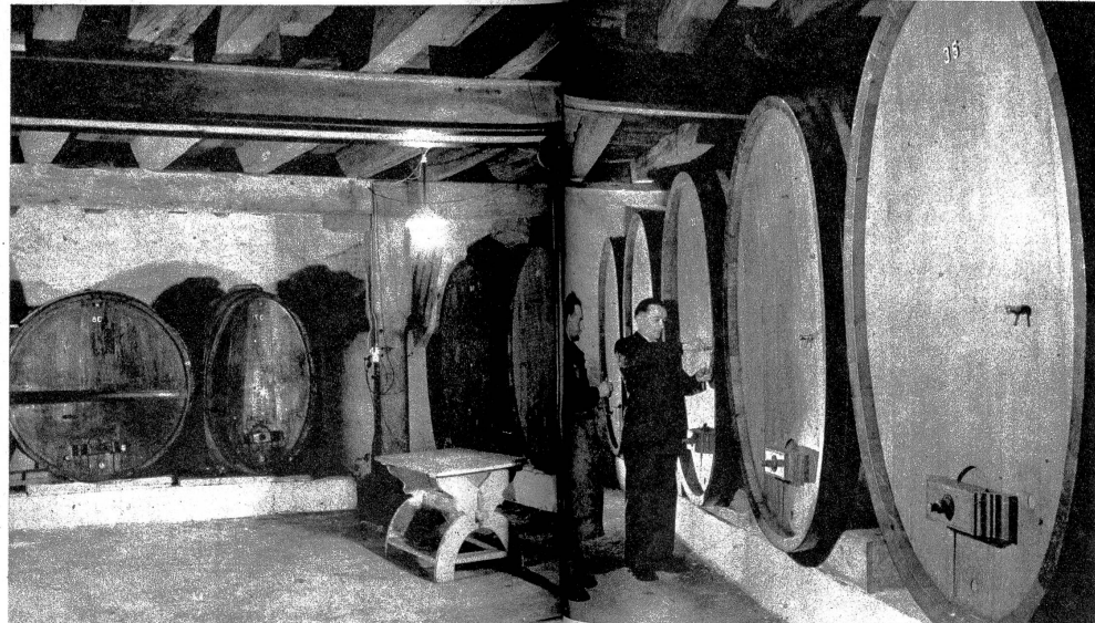
Eine ständige und fachmännische Ueberprüfung verbürgt eine tadellose Qualität. — Rechts: Die sichtbaren Standmesser an den Zementfässern erlauben eine genaue Nachprüfung des Inhalts
