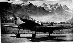
Aus den Pilatusflugzeugwerken in Stans ist soeben das neue Schweizer Schulungs- und Trainingsflugzeug «Pilatus P 2» übernommen worden. Es handelt sich um einen einmotorigen, zweiplätzigen freitragenden Tiefdecker einer einfachen und sehr robusten Konstruktion, der eine Schnelligkeit von
