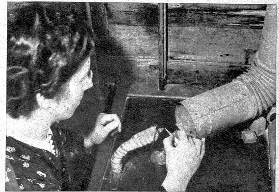
Nach dem Polieren werden die Steine vor der Kontrolle durch Ausblasen gereinigt
