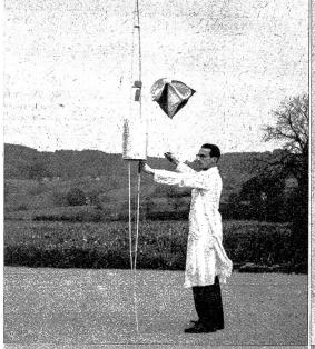
Radiosonde, auf einem Holzrahmen montiert, mit Fallschirm und Etiketten, auf der die Wegleitung für die Rücksendung des Apparates zuhanden des Finders steht
