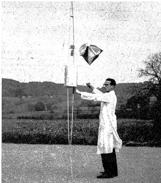
Radiosonde, auf einem Holzrahmen montiert, mit Fallschirm und Etiketten, auf der die Wegleitung für die Rücksendung des Apparates zuhause des Finders steht
