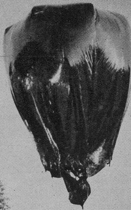
Cellux-Papierballon, bereit für einen Aufstieg. Der Inhalt des Ballons beträgt 15 m 3 . Er wird zu einem Drittel gefüllt. Während des Aufstiegs dehnt sich der Wasserstoff aus und füllt die Hülle nach und nach ganz
