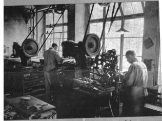
Die Bodenlederstanzen. Sohlen, Flecke usw. werden aus der Boden-lederhaut herausgestanzt. Richtiges Stanzen beruht auf grosser
