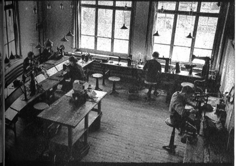
Die Stepperei. Die zugeschnittenen Schaftteile werden hier zum sogenannten Schaft zusammengeheft
