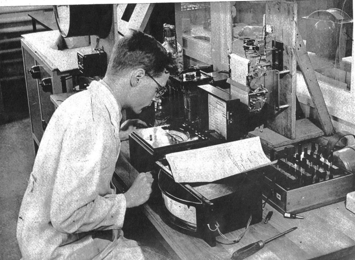
Ein Mengenmesser für alle Medien wird geeicht
