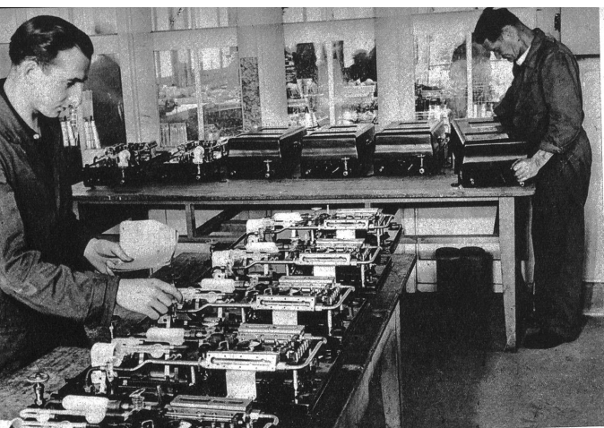
Der Rauchgasprüfer für industrielle Feuerungsanlagen
