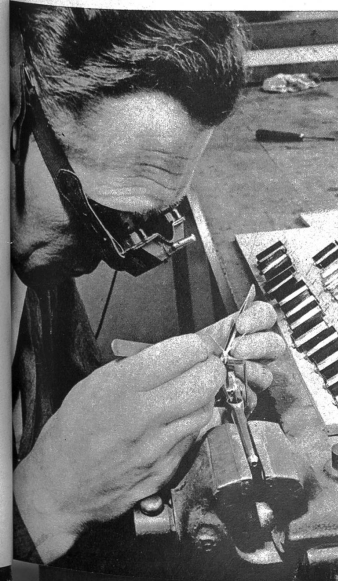
Links: Prüfung eines elektrischen Anzeiginstrumentes im Labor
