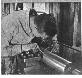
Präzisionsmessung am Kolben
