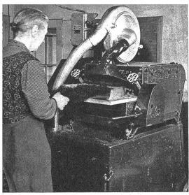
Früher wurde das Rosshaar von Hand gezupft, heute wird das besser durch die Maschine bewerkstelligt und gleichzeitig duch Saugvorrichtung entstaubt
