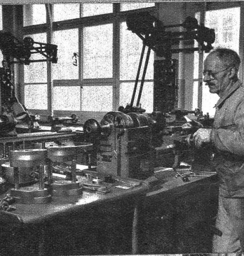
Unten: Usinage et équipement des blocs à colonne pour étampes Stanzblöcke werden zugerichtet
