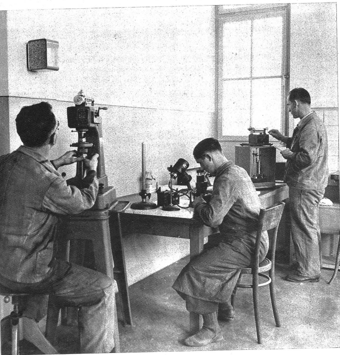
Elektrischer Warmluftofen zum Anlassen von Uhrenfedernbändern bei einer Temperatur von zirka 500°C. Automatische Kanten- und Flächenpolieranlage. Links: Die Kontrolle auf Härte und Elastizität im Labor. Rechts: Ansicht des Arbeitsraumes, in welchem die Uhrenfedernbänder zu Spiralen gewickelt werden
