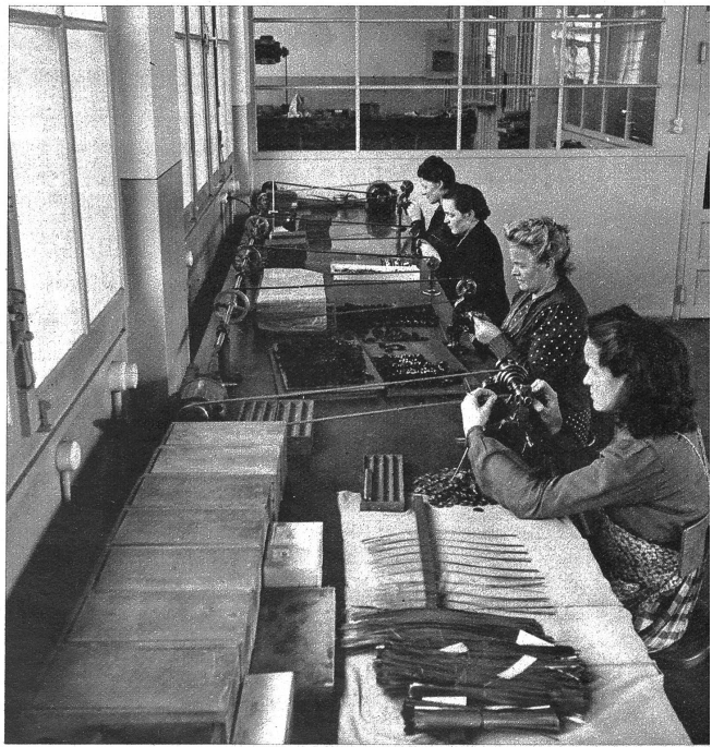
Elektrischer Warmluftofen zum Anlassen von Uhrenfedernbändern bei einer Temperatur von zirka 500°C. Automatische Kanten- und Flächenpolieranlage. Links: Die Kontrolle auf Härte und Elastizität im Labor. Rechts: Ansicht des Arbeitsraumes, in welchem die Uhrenfedernbänder zu Spiralen gewickelt werden
