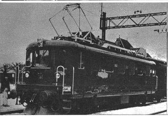
Die erste der zwei durch Brown Boveri in Baden und die Schweiz. Lokomotivfabrik in Winterthur gebauten neuen Schnellzugslokomotiven AE 4/4 ist nun von der Bern-Lötschberg-Simplon-Bahn in den regelmässigen Dienst genommen worden. Dadurch werden wesentliche Verkürzungen der Fahrzeit bei gesteigerter Leistungsfähigkeit möglich
