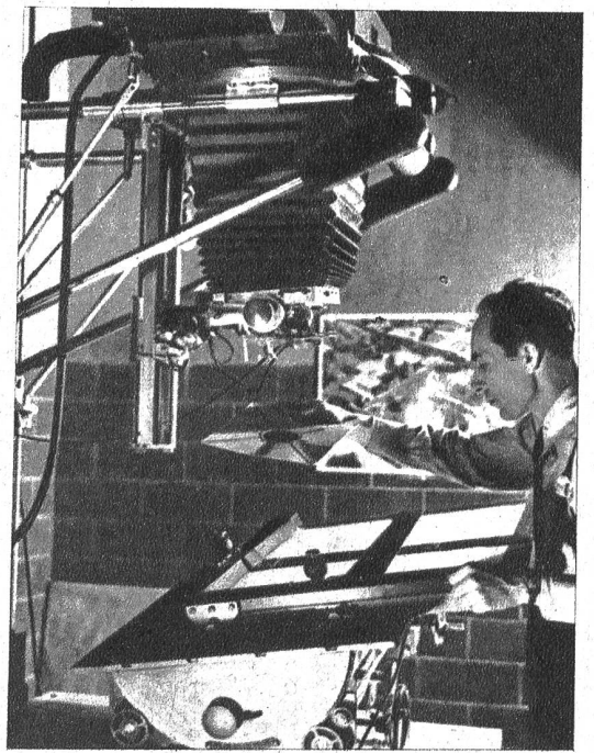
Korrektur der durch unregelmässigen Flug verursachten Fehler der Luftaufnahmen mittels sogenannter gestürzten Linsen
