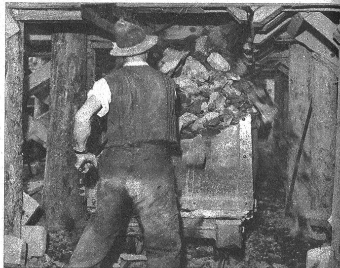
Auslad von zerkleinertem Rohmaterial mittelst Sektorschauzen aus einem Stollensilo
