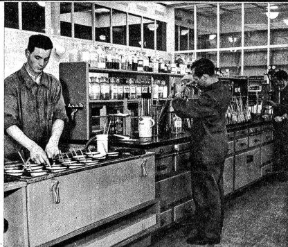
Chemisches Laboratorium der Färberei in Roggwil. Hier wird jeder Färbegang wissenschaftlich vorbereitet. Daneben besteht ein physikalisches Laboratorium zur textiltechnischen Untersuchung der Rohmaterialien, Gespinste und Gewebe
