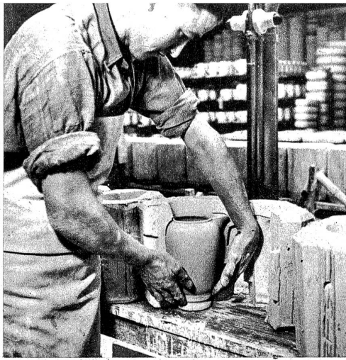
Die gegossene Porzellankanne wird aus der zweiteiligen Gipsform herausgenommen
