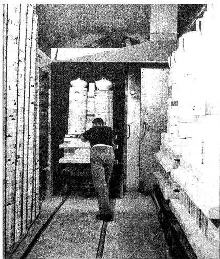
glasierte Porzellan fährt in den elektrischen Tunnelofen ein zum Glattbrand bei 1400°
