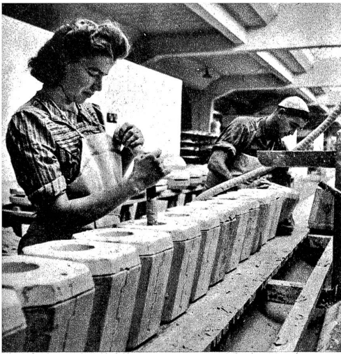
Die flüssige Porzellanmasse (Schlicker) wird in die Gipsformen gegossen
