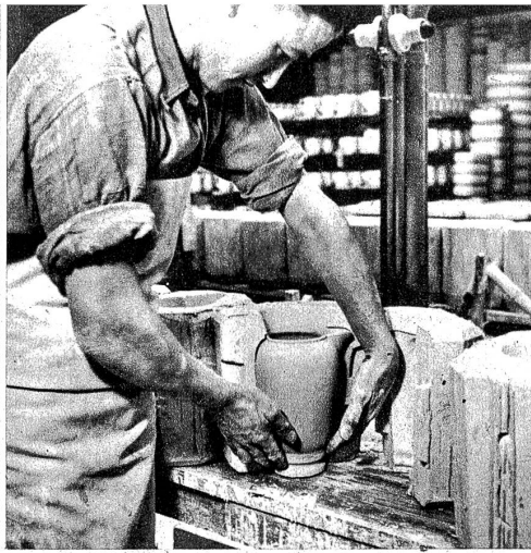
Die gegessene Porzellananne wird aus der zweiteiligen Gipsform herausgenommen
