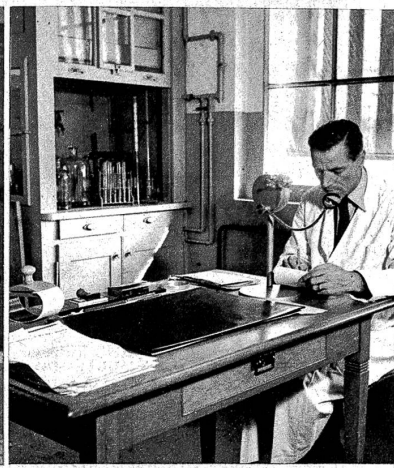
Im Laboratorium der Fabrik. Arbeit am Refraktometer für Zuckerbestimmung
