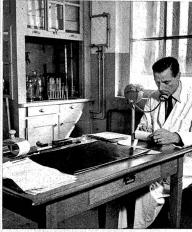
Im Laboratorium der Fabrik, Arbeit am Refraktometer für Zuckerbestimmung
