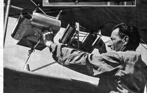
Unterdessen wird der Meteorograph, welcher die Flughöhe, die Lufttemperatur und die Feuchtigkeit registriert, in Gang gesetzt
