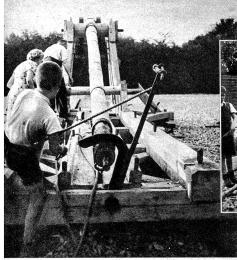
"Zum Wurf fertig!, Los!" Das Probeschiessen mit der fertigen Blide hat begonnen. Durch die Zwölfzentnerlast des Gegengewichtskastens wird die baumstarke Rute hochgeschleudert und mit ihr auch die Schleudertasche mit dem 3 Kilogramm schweren Stein, der 150 bis 300 Meter weit filiegt
