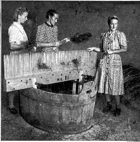
Ein riesiger Kamm dient dazu, dem Flachs die Samenkapseln abzustreifen (Fächräfteln) (Photos R. Wiedmer)
