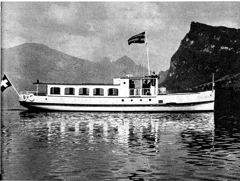
Das erste grössere Schiff mit Holzgasantrieb in der Schweiz wurde auf dem Vierwaldstättersee mit dem Motorschiff «Bürgestock» in Betrieb genommen. Die bisherigen Fahrten ergaben, dass die direkte Verfeuerung von Holz in der von der Konstruktionswerkstätte Alois Kaiser in Zug gelieferten Holzgasgeneratorenanlage sehr wirtschaftlich ist und den einheimischen Betriebsstoff neue Anwendungsmöglichkeiten eröffnen kann. (BRB. 3. 10. 39. Nr. 9930)
