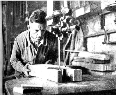
Herstellung von einem Holzschaf für die schwere Lastwinde, welche hauptsächlich in der Forst- und Landwirtschaft zur Anwendung kommt
