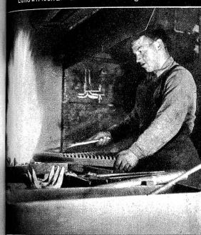
Das „Kurzwärmen“ der Zahnstange im Kohlenfeuer
