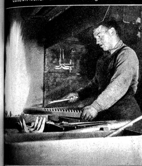
Das „Kurzwärmen“ der Zahnstange im Kohlenfeuer
