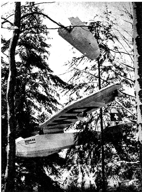
Links: Ein Segelflug-unfall, der glücklicher Weise sehr glimpflich verlaufen ist, ereignete sich bei Uebungsflügen von Hochleistungsmaschinen auf dem Albis. Infolge von Geschwindigkeitsverlust sackte ein Segelflugzeug ab und landete mitten im Wald. Der Pilot blieb unverletzt
