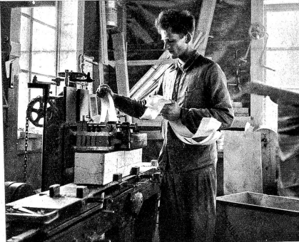
Die Maschine hobelt aus einem Trümel Holzspäne jeder gewünschten Breite und Dicke
