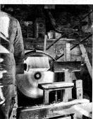
Anschliessend werden die Brettchen eingespannt und mit einer besondern Fräse die Ecken abgerundet, Boden, Deckel und die Späne werden nun zur weiteren Verarbeitung als Heimarbeit herausgegeben
