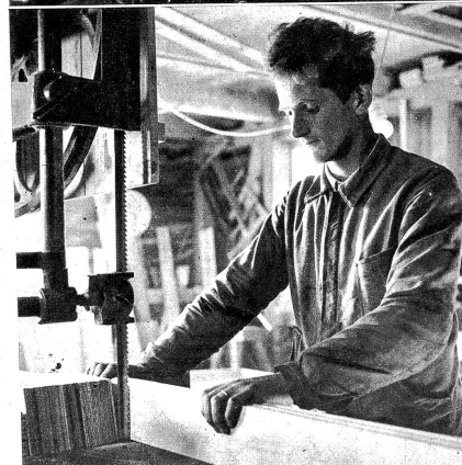
Aus Sperrholzlatten wird das Holzstück für die Böden und Deckel der Schachteln gesägt
