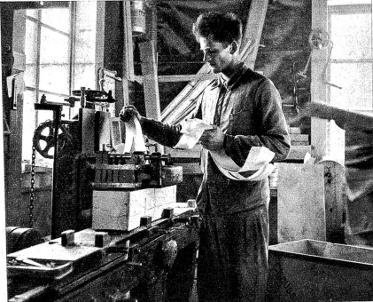
Die Maschine hobelt aus einem Trämel Holzspäne jeder gewünschten Breite und Dicke
