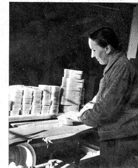
Vor der Ablieferung müssen die bereits fertigen Schachteln in der Werkstatt noch verputzt werden
