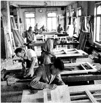
In den Werkstätten der Parquet und Holzbau AG., Bern wurden alle Bauelemente aus Holz fertiggestellt
