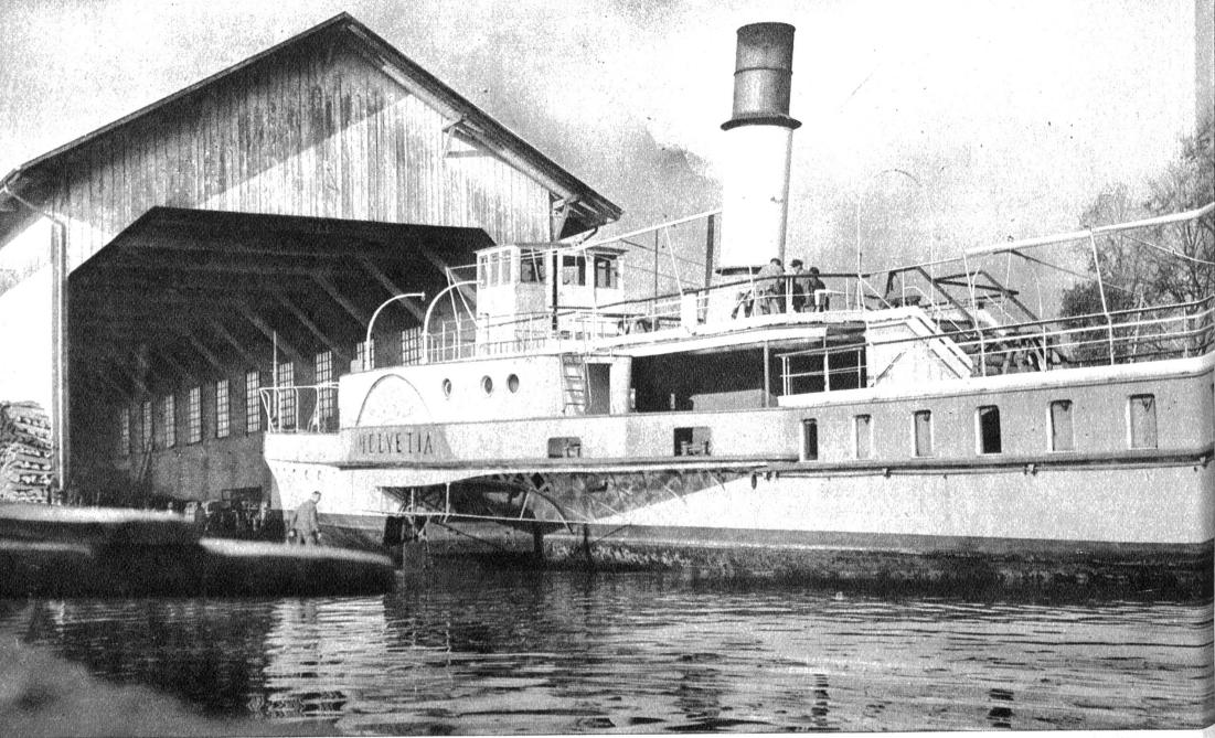
Daß ein sonst nur im nassen Element beheimatetes Schiff auch einmal auf das Trockene befördert wird, trifft so alle drei bis vier Jahre ein, wenn eine gründliche Revision notwendig wird, wie solche bei allen öffentlichen Verkehrsfahrzeugen in gewissen, durch die Beanspruchung bedingten Zeitabständen durchgeführt werden. Um bei einem Schiff den Unterwasser teil einer Revision zu unterziehen, ist es notwendig, dasselbe in den Werften aufzuziehen.
