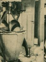
Zuerst wird den Häuptli an einer besonders dafür konstruirten Maschine der "Storzen" ausgebohrt, der meist als Viehfutter Verwendung findet
