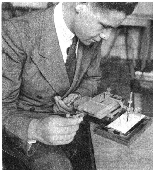
Besonders bei allen mechanischen Berufen spielt die Fertigkeit der Hand eine wesentliche Rolle. Hier wird, ähnlich wie bei einer Drehbank, am Zueihandprüfer die Fertigkeit erprobt
