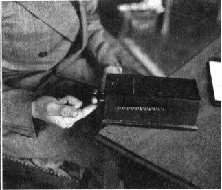
Oben: Mit diesem Apparat wird das Fingerfeingefühl gemessen. Bis auf  $^{1}I_{100}$  Gramm genau ist es möglich, dies zu registrieren
