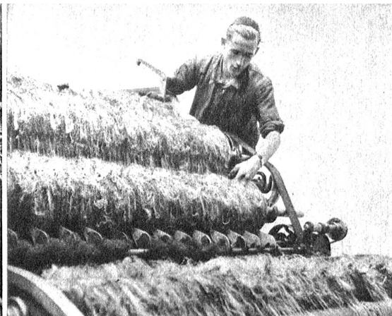
Bei der Kremperei: Das Rohmaterial wird gekardei, bevor es zur Verspinnung gelangt
