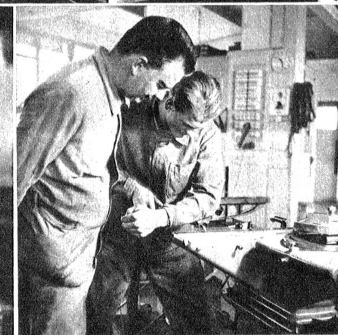
Schaben der Gleitbahnen: eine Präzisionsarbeit mit höchstem Einfluss auf die Arbeitsgenauigkeit der Maschine
