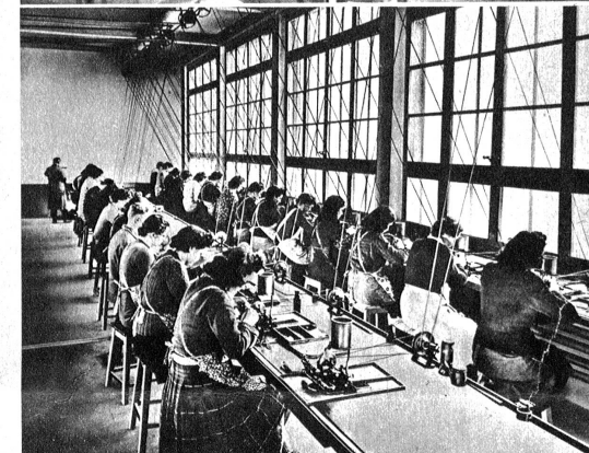
Die Steine werden vorgedreht und geformt. Oberes Bild: Auf zwei- bis vierhundertstel Millimeter (0,22 — 0,27 mm) genau werden die Planflächen der Steine von ihrer ursprünglichen Dicke abpoliert. Unten: Die geformten Steine werden mit einer Oelsänkung versehen
