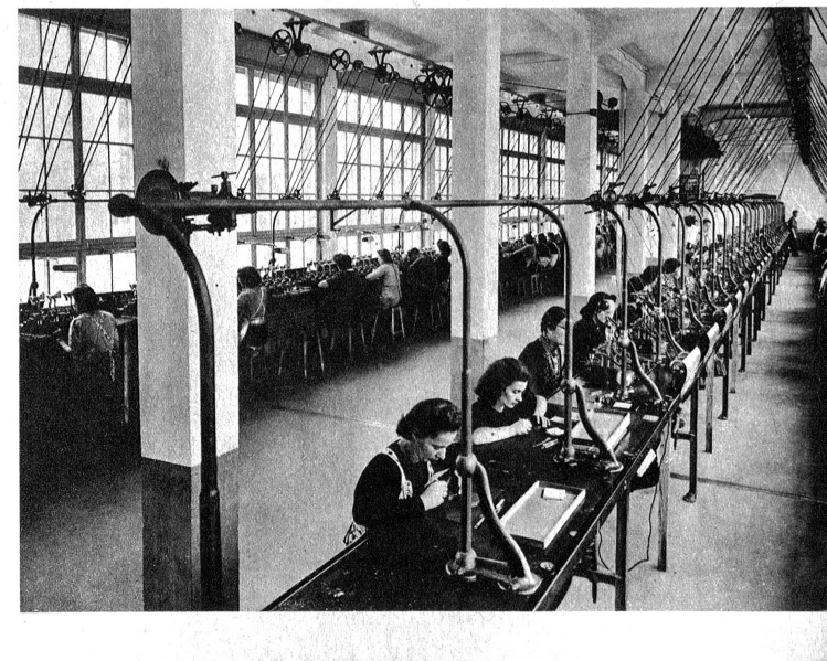
Die Steine werden vorgedreht und geformt. Oberes Bild: Auf zwei- bis vierhundertstel Millimeter (0,22 — 0,27 mm) genau werden die Planflächen der Steine von ihrer ursprünglichen Dicke abpoliert. Unten: Die geformten Steine werden mit einer Oelsänkung versehen
