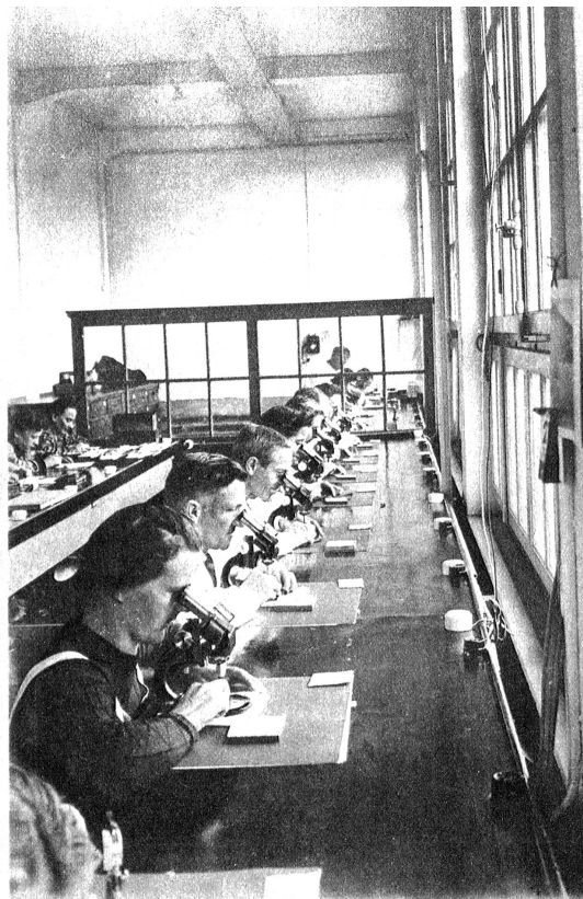
Die Kontrolle der Steine wird sorgfältig mit Zeiss-Mikroskopen vorgenommen Unten: Das Polieren der gewölbten und abgerundeten Flächen der Steine erfordert nur gut geschultes und erfahrenes Personal
