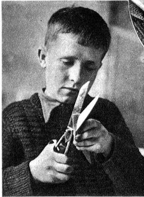
Ausschneiden einer Flügelrippe aus Sperrholz
