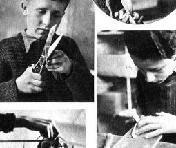
Eine Flügelrippe wird nach dem Ausschneiden mit der Feile sehr sorgfältig bearbeitet
