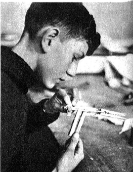
Eine Flügelrippe wird nach dem Ausschneiden mit der Feile sehr sorgfältig bearbeitet
