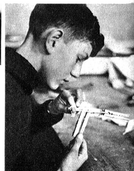
Beim Verleimen der einzelnen Bauteile sind Wäscheklammern ein wertvolles Hilfsmittel; ja, sie sind sogar unentbehrlich
