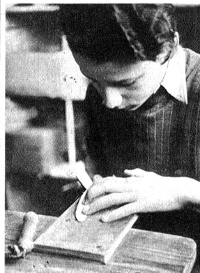
Eine Flügelrippe wird nach dem Ausschneiden mit der Feile sehr sorgfältig bearbeitet
