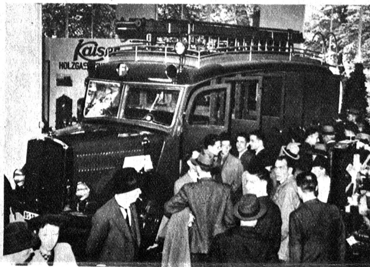
An der Mustermesse in Basel ist die von der baselstädtischen Feuerwehr erworbene modernste Automobilspritze der Schweiz ausgestellt. Sie hat eine Minutenleistung von 3000 l und enthält neben Leitern, Schläuchen etc. auch Gasschutzgeräte und Pulmotor
