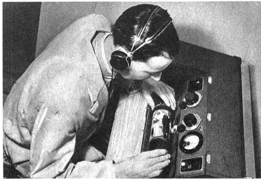
Empfangs- und Sendeapparat für radiotelegraphische Bildübermittlung in der Schweiz. Eine photographische Aufnahme wird auf die drehbare Walze aufgespannt. Die erste photographische Aufnahme aus der Schweiz wurde am 8. März 1943 durch die Photopress ausgestrahlt. Sie wurde in 20 Minuten von der Schweiz nach den USA übertragen
