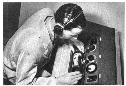
Empfangs- und Sendeapparatur für radiotelegraphische Bildübermittlung in der Schweiz. Eine photographische Aufnahme wird auf die drehbare Walze aufgespannt. Die erste photographische Aufnahme aus der Schweiz wurde am 8. März 1943 durch die Photopress ausgestrahlt. Sie wurde in 20 Minuten von der Schweiz nach den USA übertragen
