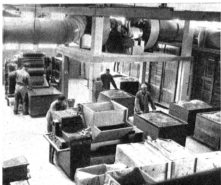
Der Verpackungsraum, in dem die Schachteln mit dem Bienna 7 Waschpulver versandbereit gemacht werden. Rechts: Fertige Seife wird mit dem Markenstempel versehen. Unten: Die aus den Trockenapparaten kommenden Seifenflocken werden auf kleinen Handwagen zum Verpackplatz gebracht
