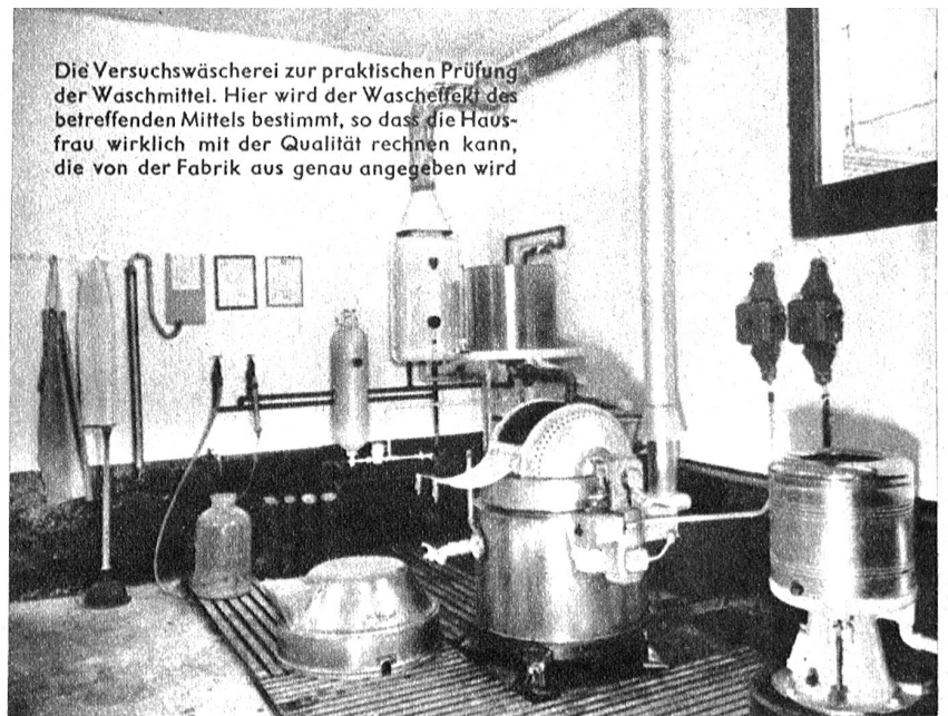
In den Räumen, wo die Verseifung stattfindet, geht es heiss zu Mitte: Mit einem entsprechenden Apparat wird der Wascheffekt der Waschmittel zahlenmässig festgestellt und der Sauberkeitsgrad der gewaschenen Wäschestücke ermittelt
