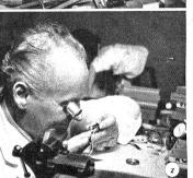
1 Das genaue Arbeiten der Rolex - Uhr - Perpetual der sich selbst aufziehenden Uhr beruht ausschliesslich auf dem präzisen Einpassen der kleinen Teile auf hundertstel Millimeter
